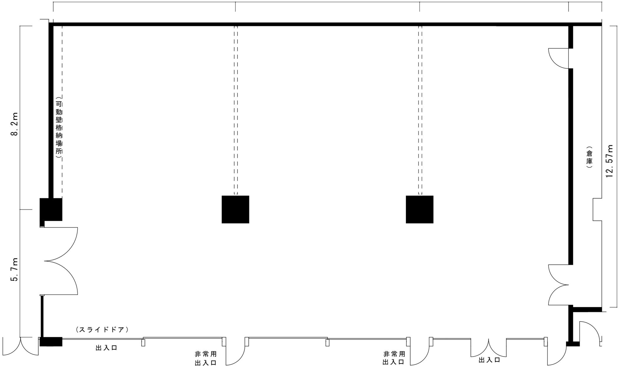
● ----- 可動壁を表す 可動壁サイズ 幅7.5m 高さ3.3m 厚さ0.15m
